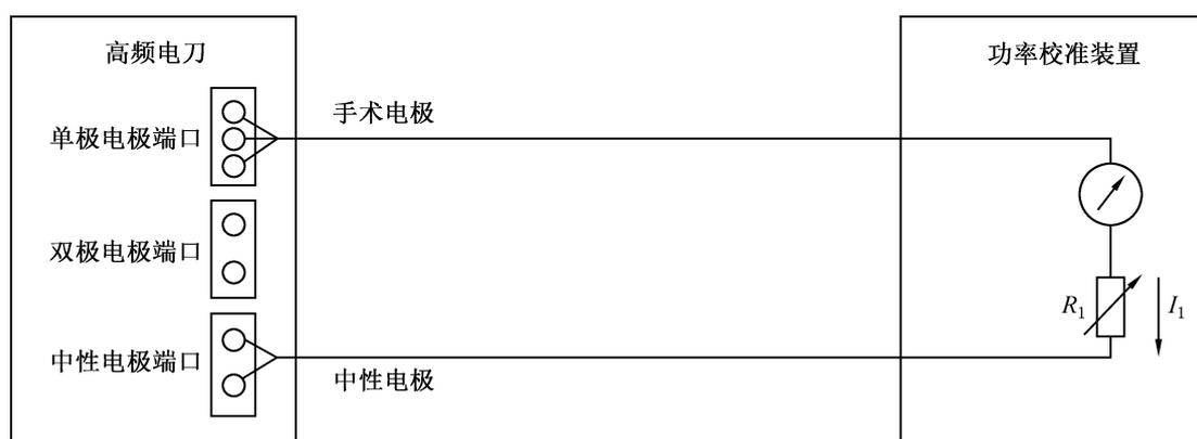
图 1 单极模式输出功率校准
