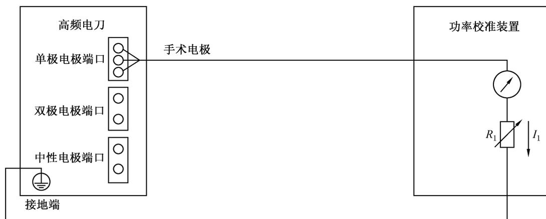
图7 手术电极漏电流测量
